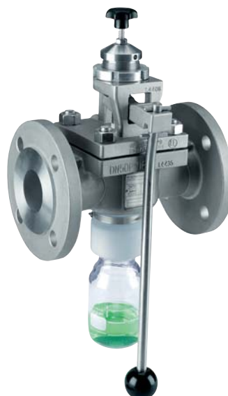
Vannes de prise d'échantillon, sans presse-étoupe, revêtement en PFA, acier inox
